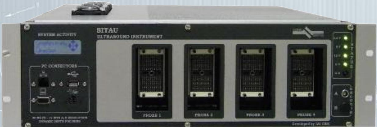
Es la solución ideal para inspecciones Phased Array que requieran aperturas activas mayores a 128 elementos.
